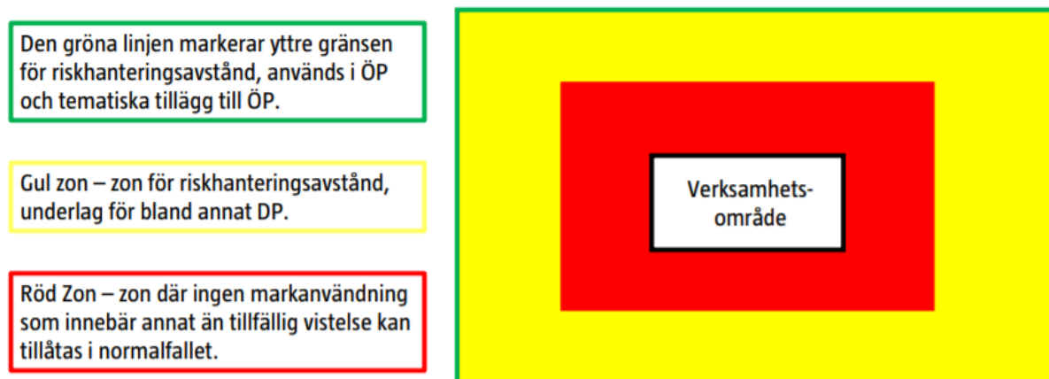
Figur 1. Illustration över riskhanteringsavståndet och tänkt användning för verksamheter som hanterar brandfarliga gaser, brandfarliga vätskor och oxiderande ämnen. Den gröna linjen representerar den yttre gränsen för riskhanteringsavståndet. Olyckor inom verksamheten förväntas ej kunna medföra personskador bortanför grön linje. Vid planläggning inom den gula zonen befinner man sig inom riskhanteringsavståndet vilket kräver att vidare analyser genomförs för att avgöra om tilltänktmarkanvändning är lämplig. Den röda zonen är normalt olämplig att använda för markanvändning som medför stadigvarande vistelse i området [2].
