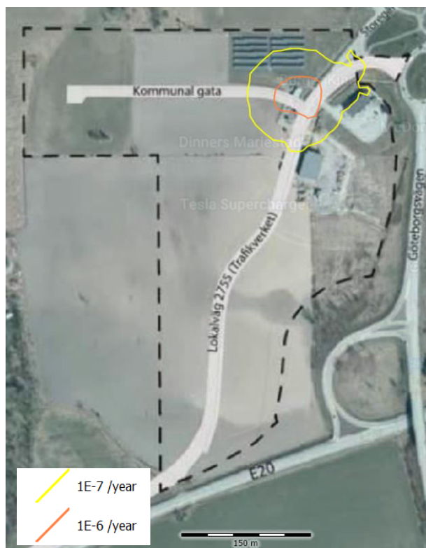
Figur 6-1 Individriskkonturer för befintlig placering av vätgasanläggning.
