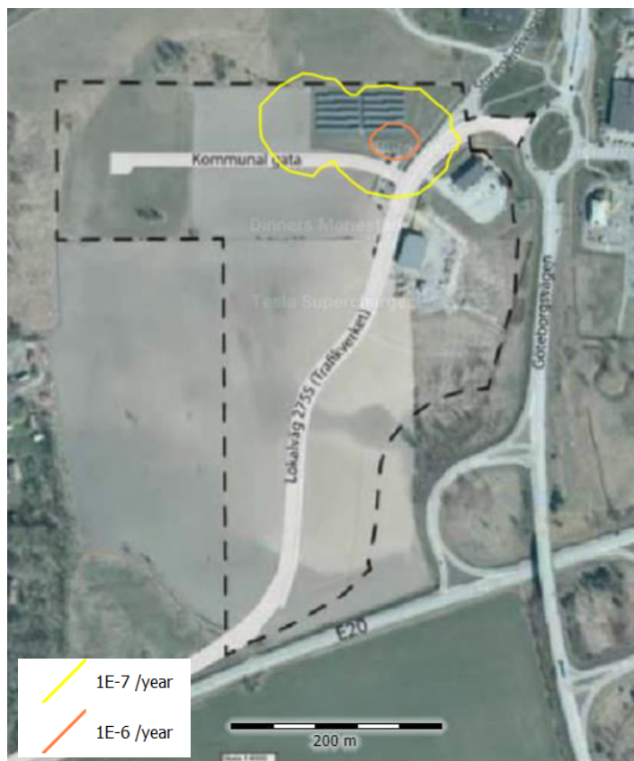
Figur 6-2 Individriskkonturer för planerad framtida placering av vätgasanläggning.
