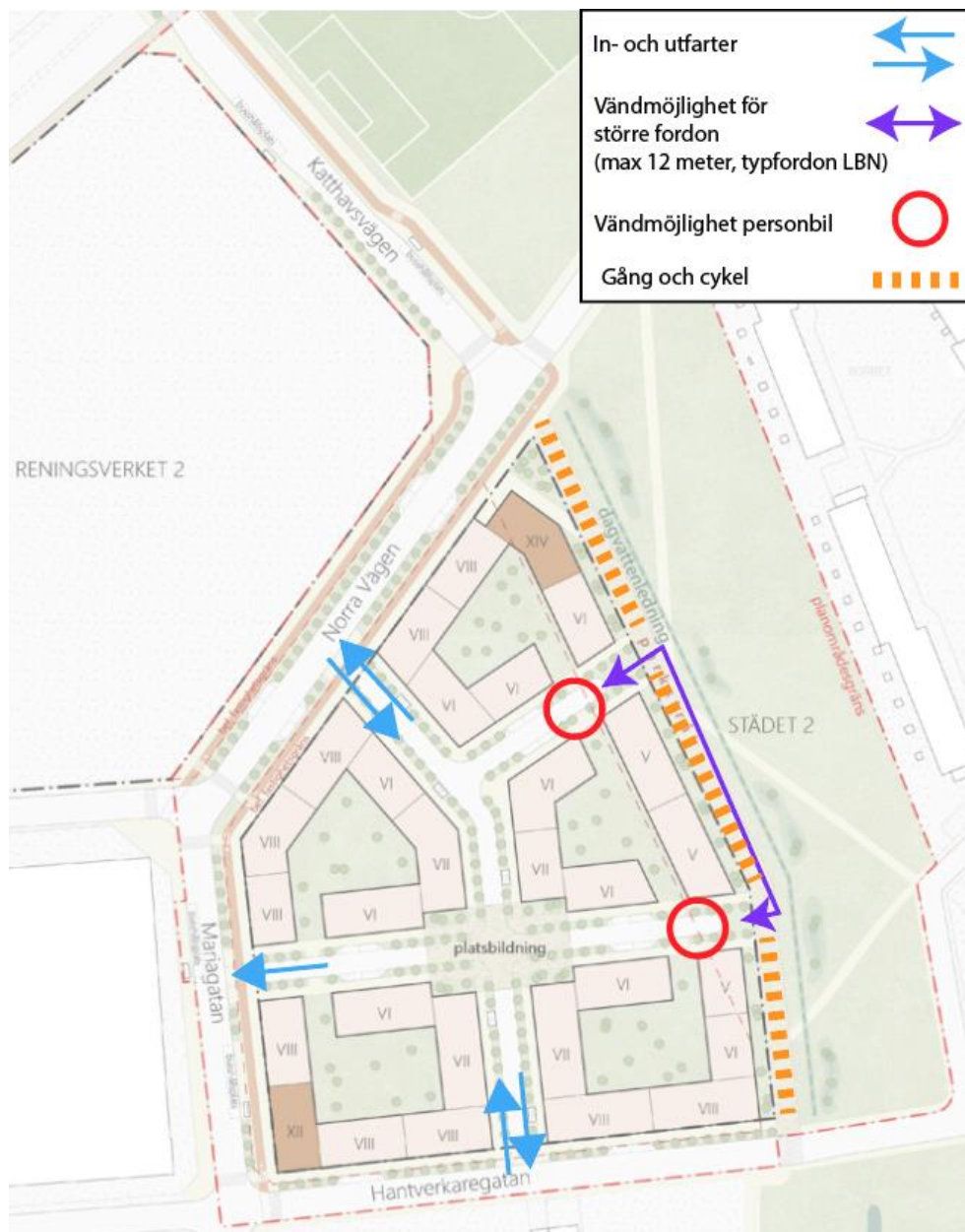
Figur 17. Förslag på trafiklösning för avfallshantering, varutransporter och tillgänglighetsanpassad trafik.
