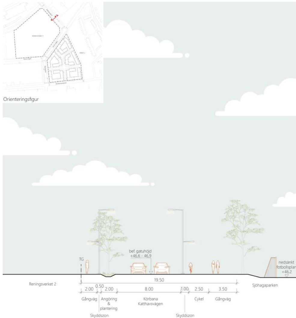
Figur 18. Gatusektion A-A Katthavsvägen, framtagen av Ateljé Nord.
