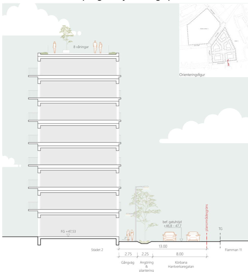
Figur 21. Gatusektion D-D steg 1, Hantverkaregatan, framtagen av Ateljé Nord.
