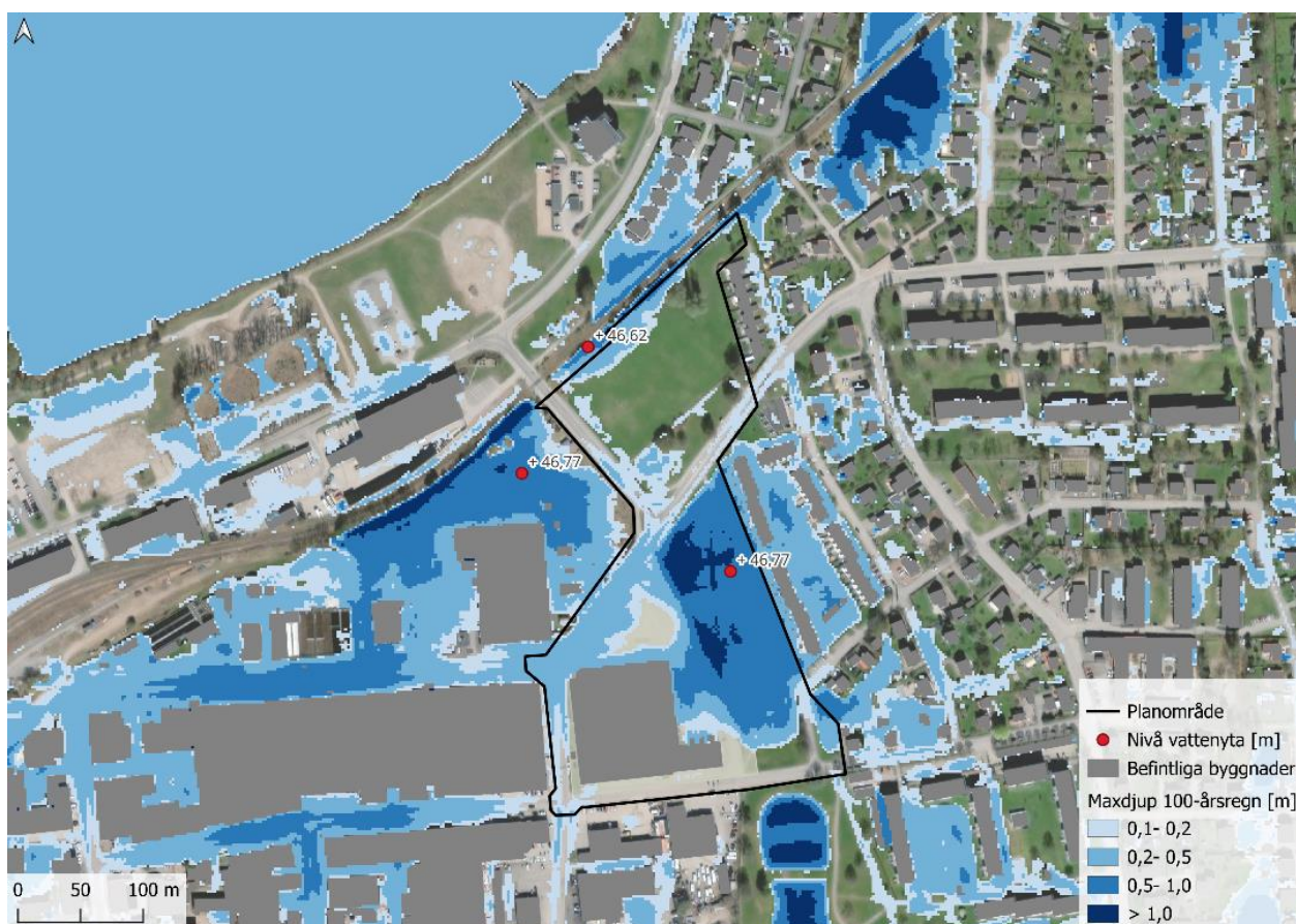
Figur 2-4 Maxdjup vid simulering av ett 100-årsregn vid befintlig situation. Planområdesgränsen har justerats något sedan översvänningsanalysen. Detta bedöms däremot inte påverka resultatet.
