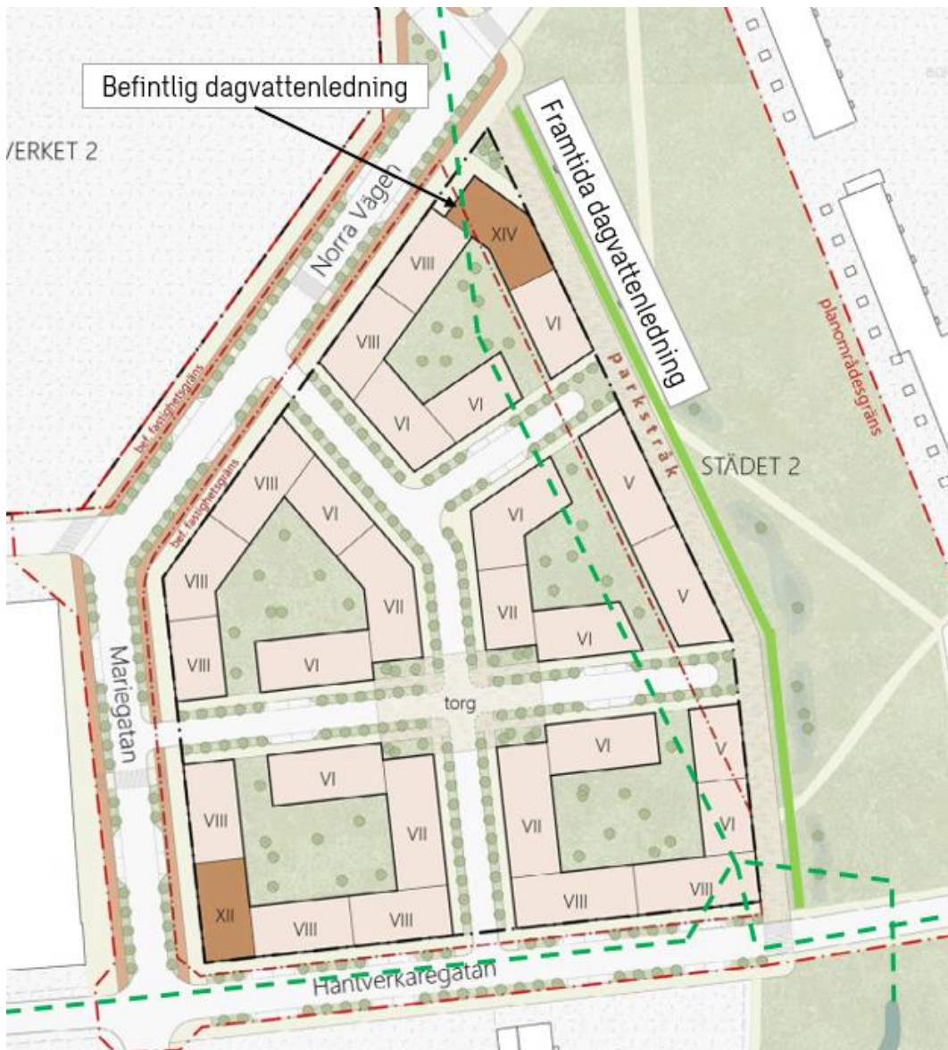
Figur 7-14 Placering av befintlig dagvattenledning och framtida placering i förhållande till planerad struktur.
