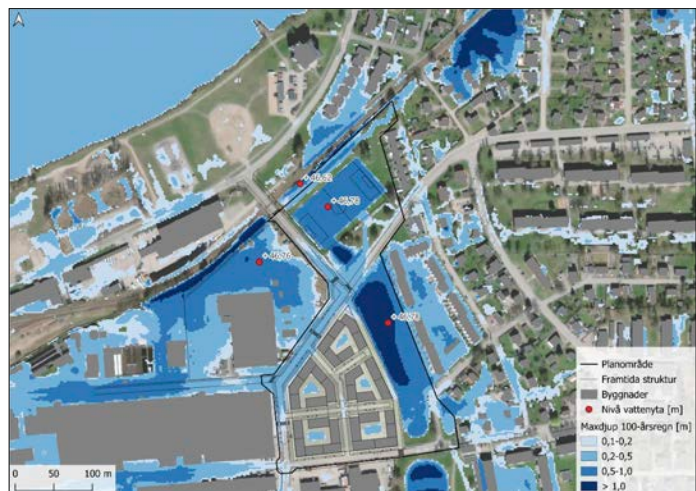
Figur 2. Maxdjup vid simulering av ett klimatkompenserat 100-årsregn vid framtida situation.
