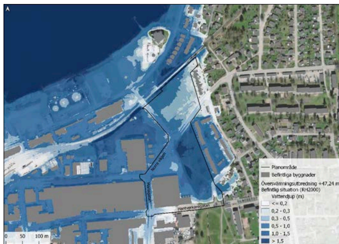
Figur 3. Översvämningens utbredning för befintlig situation vid vattennivån +47,24 m (RH2000) i Mariestadssjön tillsammans med det vattendjup som skapas. Sweco 2024
