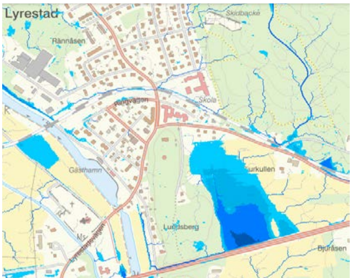
Kartering som visar lågpunkter och avrinning av dagvatten - utdrag ur Länsstyrelsens karteringstjänst
