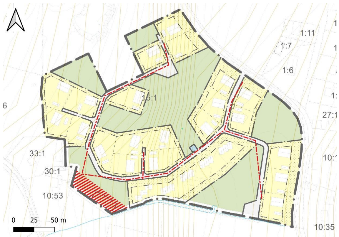
Figur 20. Möjlig ledningsdragning visas med röd streckad linje. Förslag till lokalisering av behandlingsanläggning för avloppsvatten visas som röd-rastrerat område. Höjdkurvor, en meters ekvidistans, visas i gult. Figuren illustreras på en plankarta (samrådshandling) från 2024-01-19.
