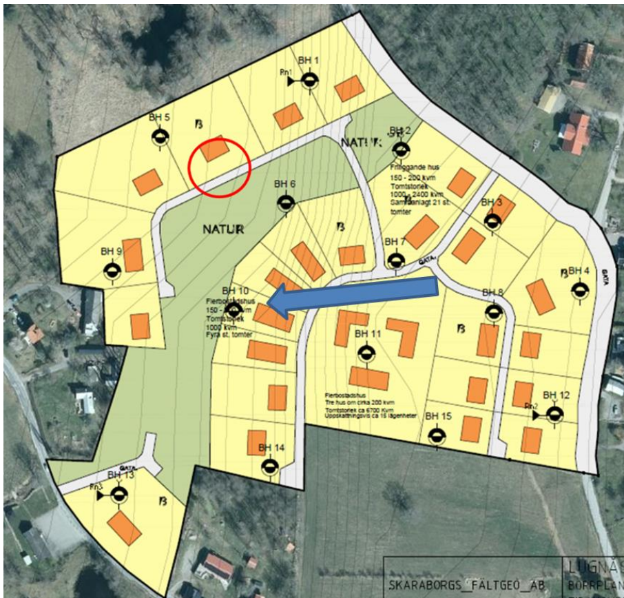
Figur 10. Karta över borrhål för genomförd markteknisk undersökning. Röd ring markerar "mycket blött område". Blå pil visar grundvattnets flödesriktning i jordlagren. Källa: Modifierad utifrån (Skaraborgs Fältgeo AB, 2021). Observera att detaljplanen (även planområdesgräns) har ändrats sedan figuren skapades.
