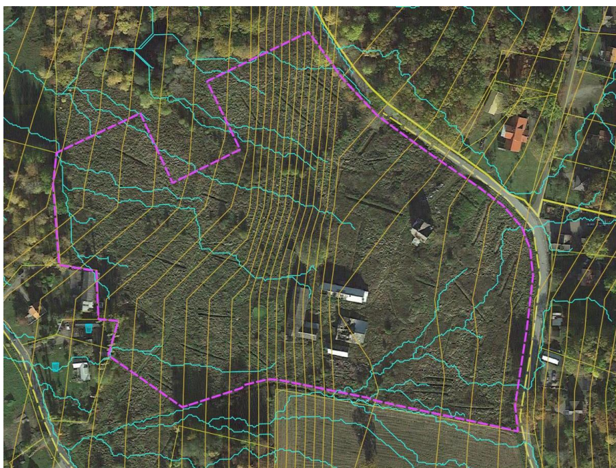
Figur 21. Översikt över hur vattnet avrinner ytleddes i nuläget. Rinnvägar går i västlig riktning. Observera att befintlig väg öster och söder om planområdet troligtvis fungerar som avdelare och att vattnet inte rinner över vägen in i planområdet. Källa:(© Lantmäteriet, 2022).
