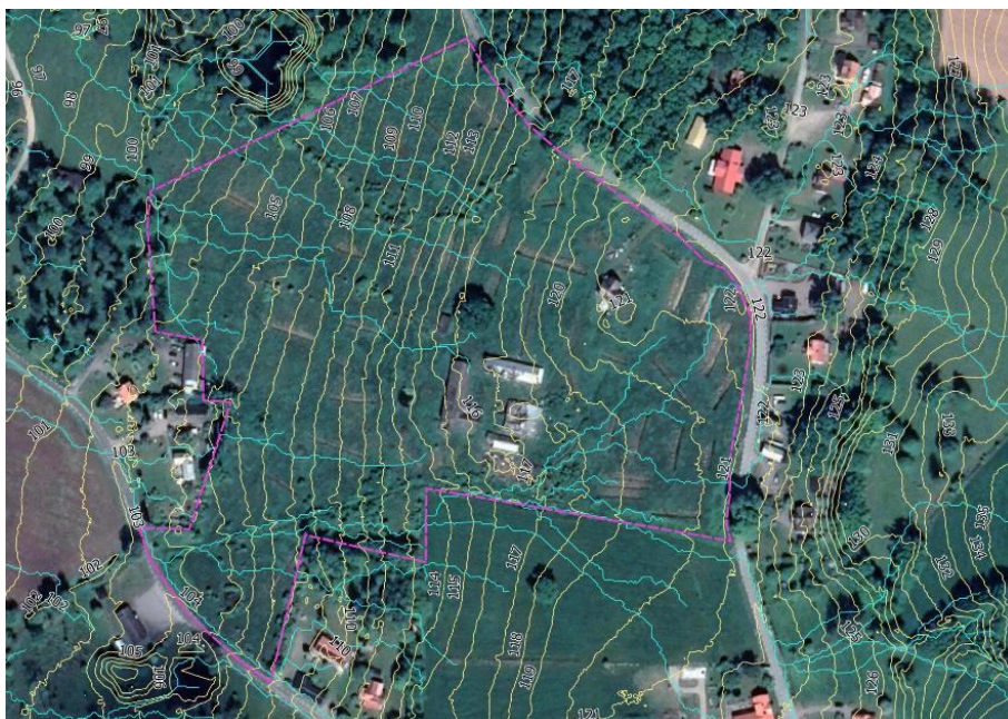
Figur 22. Översikt över hur vattnet avrinner ytledes i nuläget. Rinnvägar går i västlig riktning. Observera att befintlig väg öster och söder om planområdet troligtvis fungerar som avdelare och att vattnet inte rinner över vägen in i planområdet. Källa: (© Lantmäteriet, 2022).
