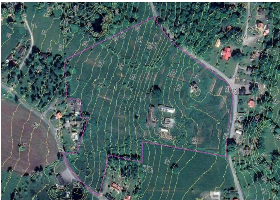
Figur 4. Höjdkurvor markerade i gult med en ekvidistans på 1 m (© Lantmäteriet, 2022). Planområdet visas med rosa streckad linje.
