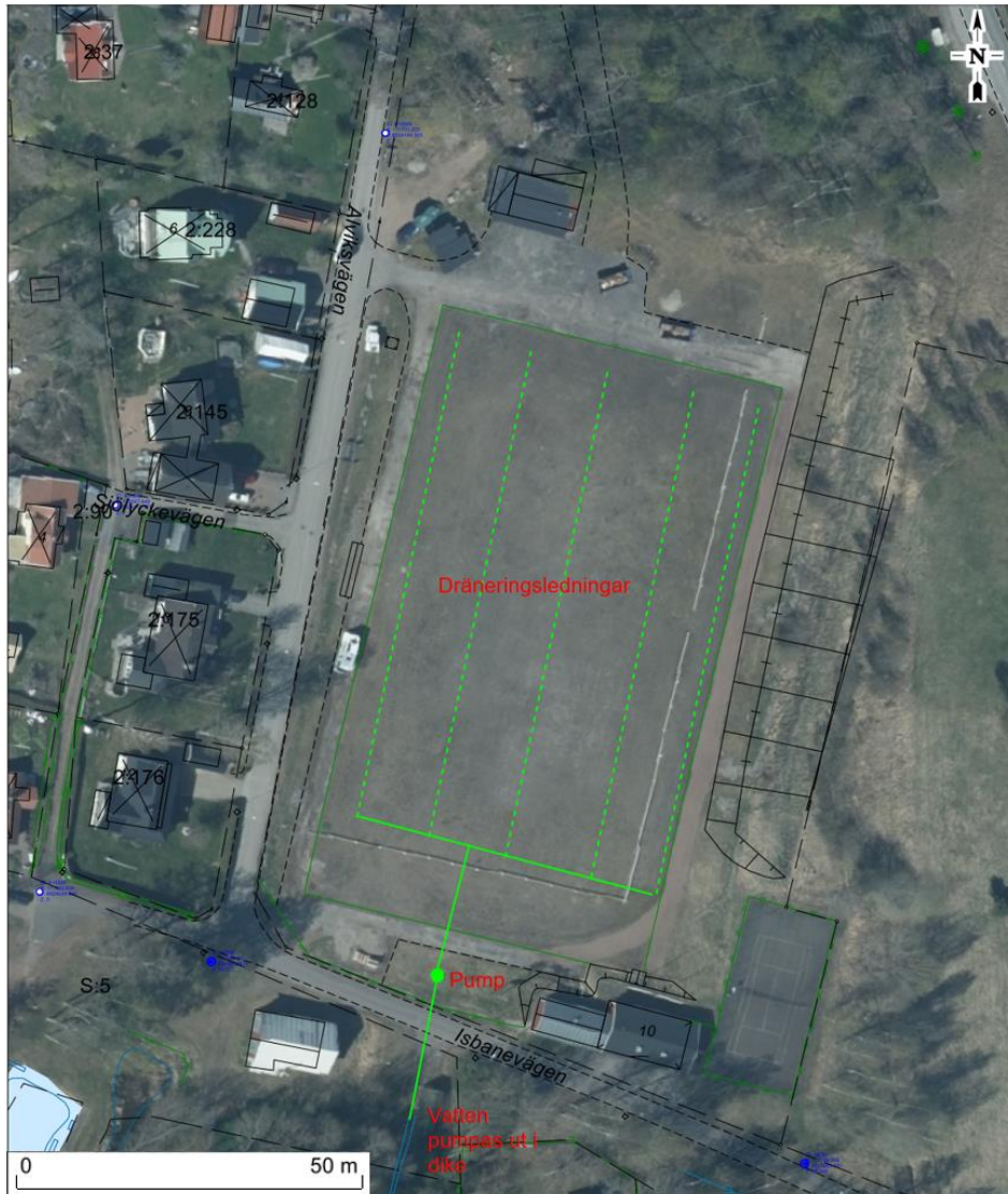
Figur 7 Dräneringssystemet under grusplanen.
