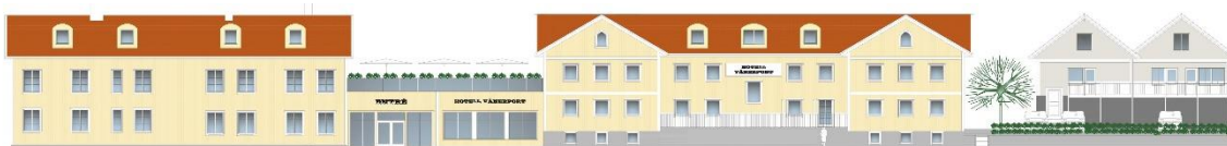
Exempel på ibopbyggnad som skapar ett gemensamt fasadliv med tydlig läsbarhet mot Hamngatan. Bild Vara byggkonsult.
