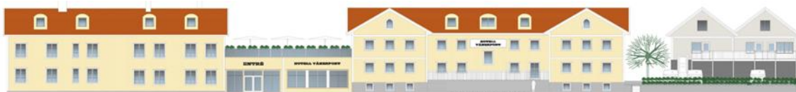
Exempel på ihobyggnad som skapar ett gemensamt fasadliv mot Hamngatan. Bild Vara byggkonsult.
